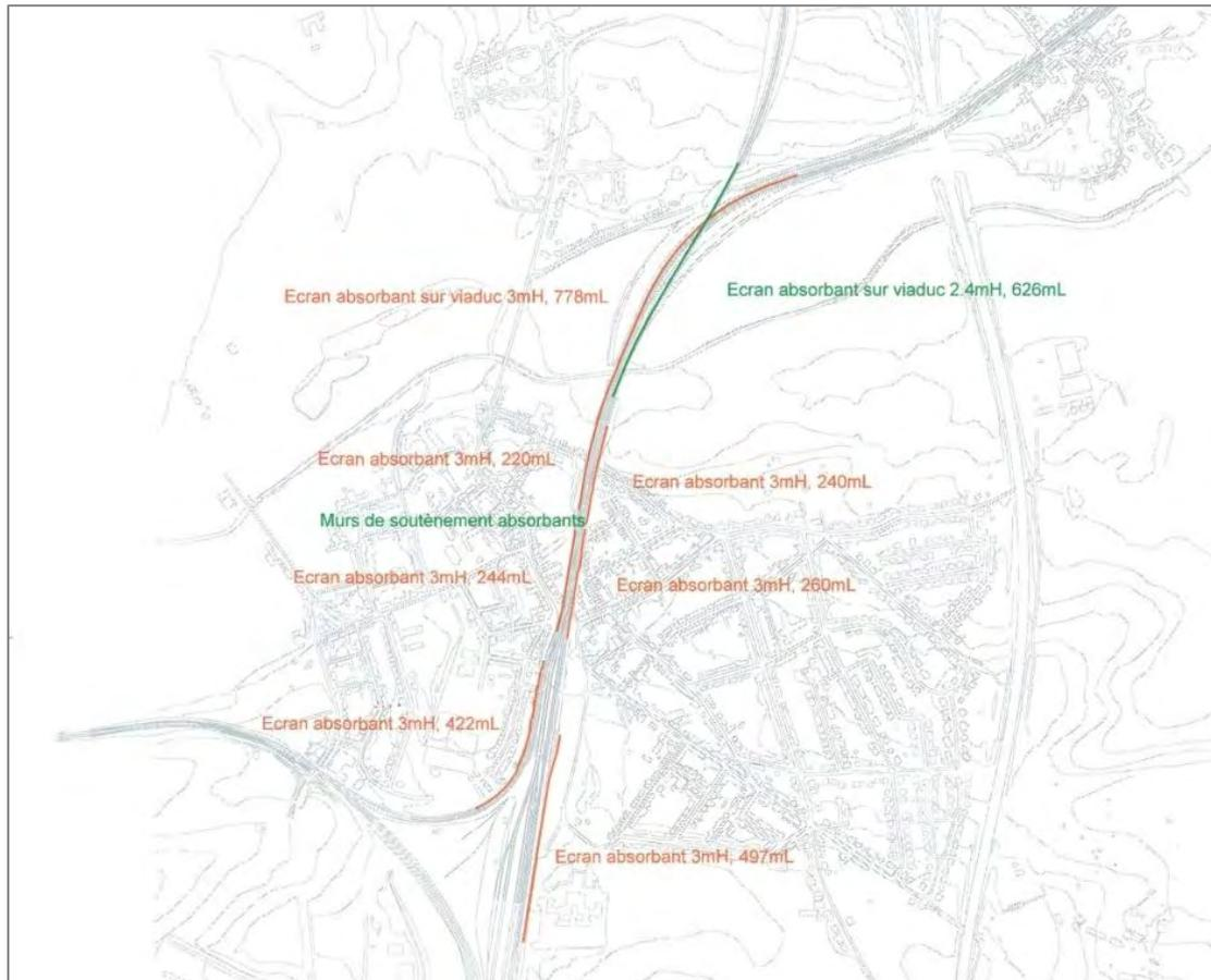
**Abbildung 3: Darstellung der geplanten Lärmschutzwände für Bettemburg**
