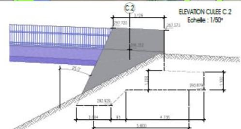
COUPE LONGITUDINALE DANS L'AXE DE LA STRUCTURE METALLIQUE
